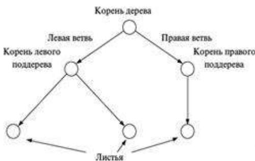
**Ориентированное (направленное) дерево** — ациклический орграф (ориентированный граф, не содержащий циклов), в котором только одна вершина имеет нулевую степень захода (в неё не ведут дуги), а все остальные вершины имеют степень захода 1 (в них ведёт ровно по одной дуге). Вершина с нулевой степенью захода называется корнем дерева, вершины с нулевой степенью исхода (из которых не исходит ни одна дуга) называются
